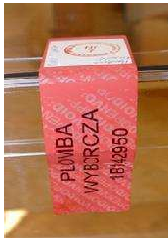
Plomba odklejona i przyklejona ponownie . Na całej powierzchni plomby pojawiły się „srebrne” napisy informujące o naruszeniu plomby.
