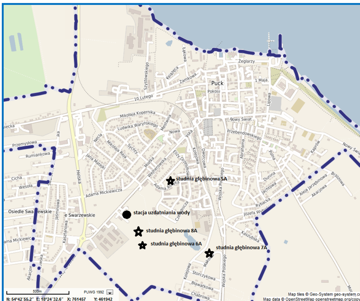
Rozmieszczenie studni głębinowych i stacji uzdatniania wody
